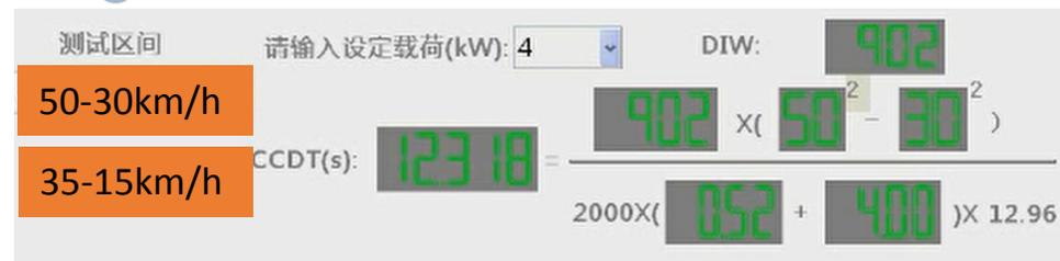
② 对负荷为**11kW**的加载滑行测试，50km/h~30km/h滑行测试、35km/h~15km/h滑行测试时滑行测试时间与名义时间(CCDT)之间的偏差应该在**±2%**之内；
