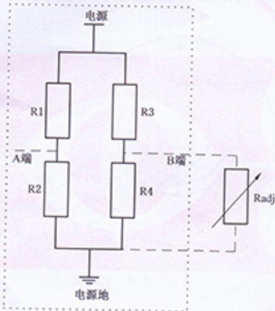
图 D.1 模拟信号加载示意图
