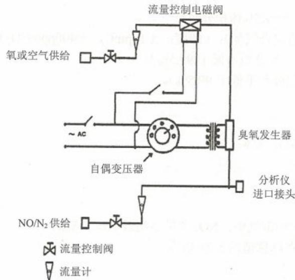
图 C.4 NO<sub>x</sub> 转化器效率测试装置示意图
