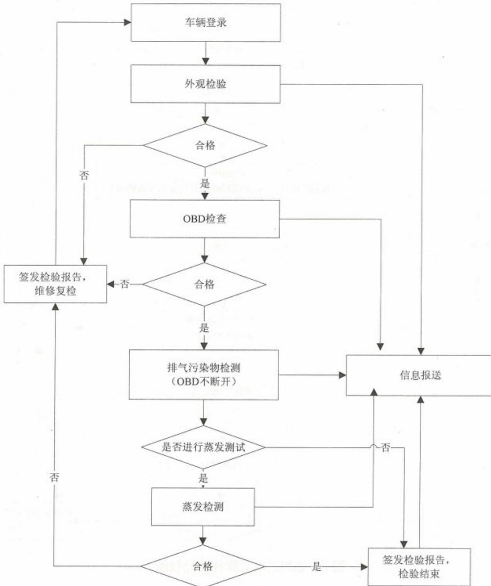
图 2 注册登记检验流程图
