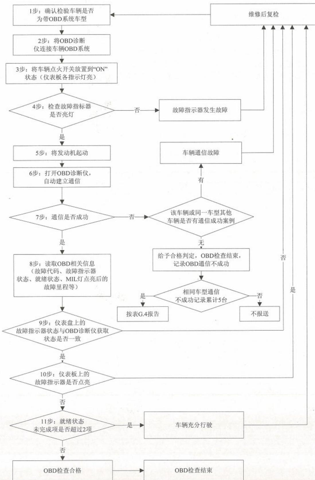
图 F.1 OBD 系统检验流程示意图
