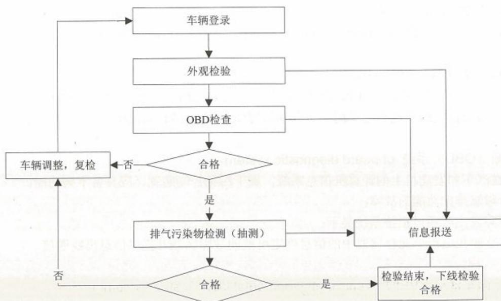
图 1 新车下线环保检验流程图
