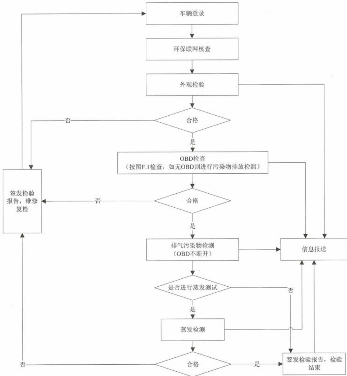
图3 在用汽车环保检验流程图
