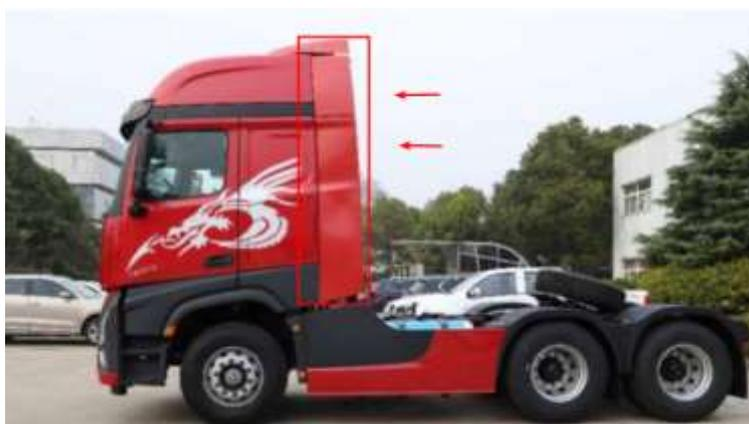
图 2-44 车辆后部导流装置
