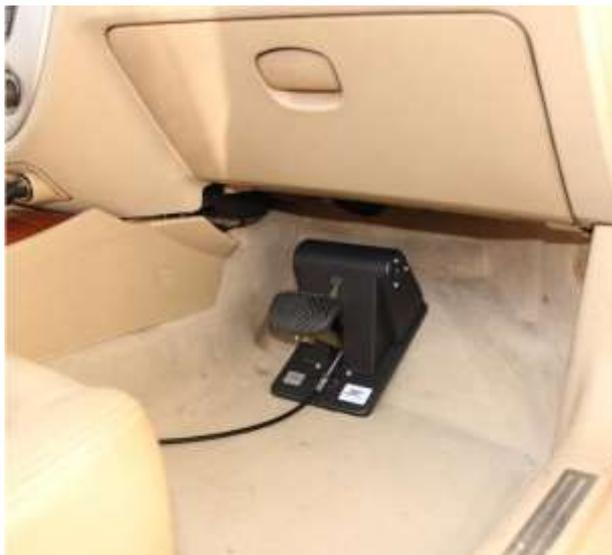
图2-25自学用车装备的副制动踏板
