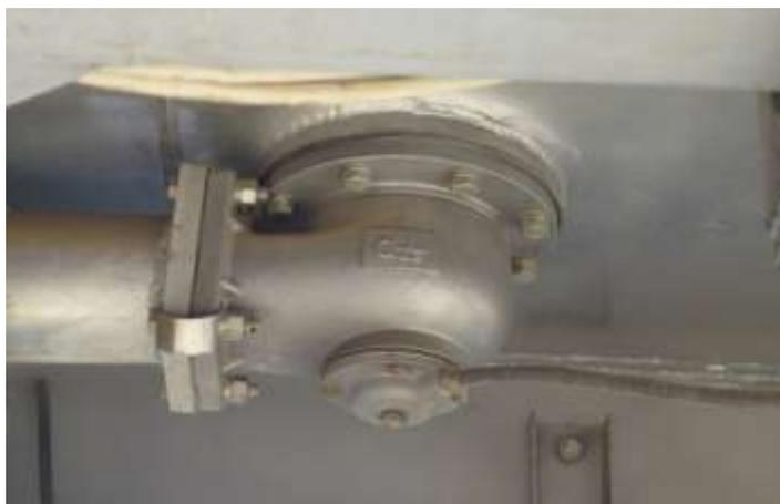
图2-21 紧急切断阀
