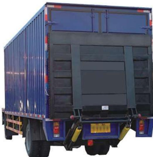
图 2-45 收起状态的水平长度不超过 300 mm 的尾板、上下坡道及类似装置
