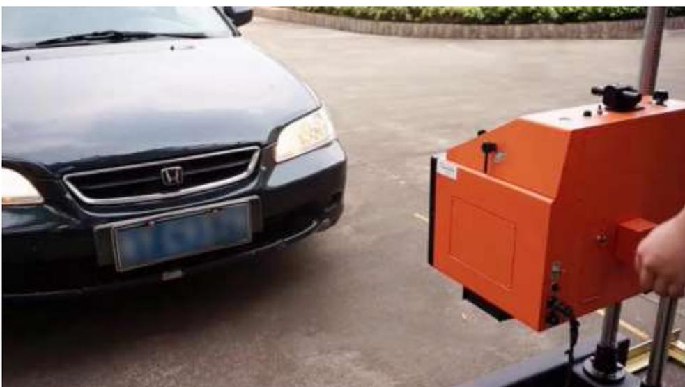
图 2-69 使用手动灯光仪进行前照灯检测
