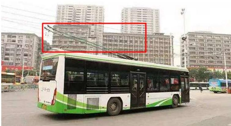
图 2-43 电力车辆的集电装置
