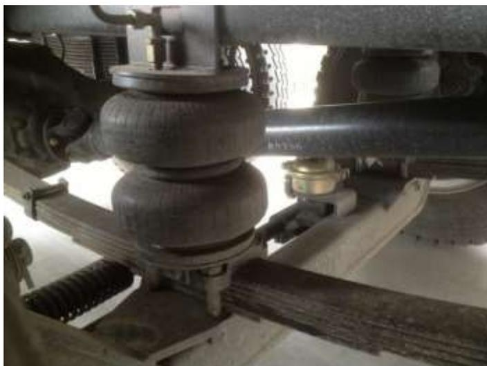
图2-5 空气悬架和钢板弹簧悬架复合设置
