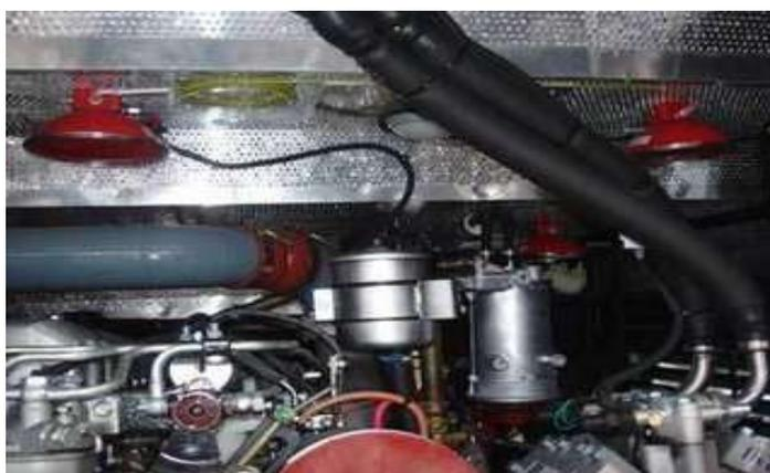
图2-23 发动机舱自动灭火装置图
