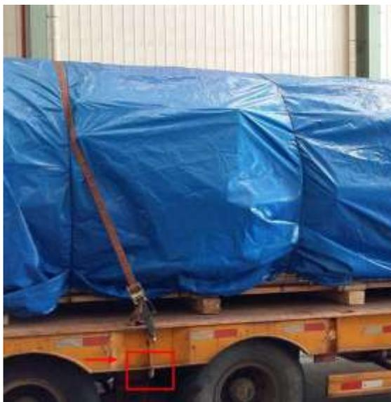
图 2-36 用于栓固防雨布的装置
