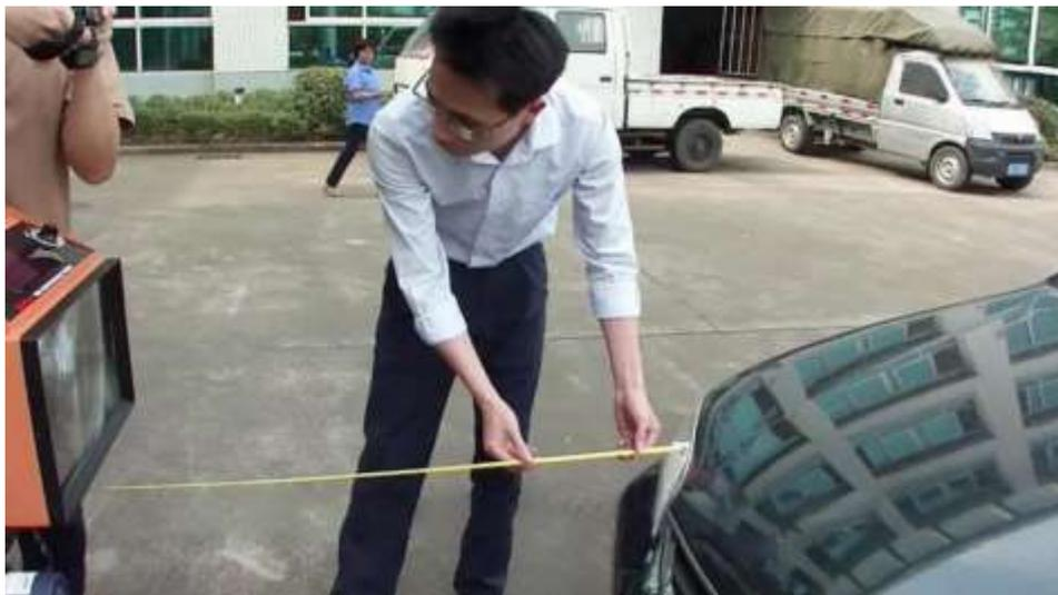
图 2-68 确定灯光仪与被检车辆前照灯距离
