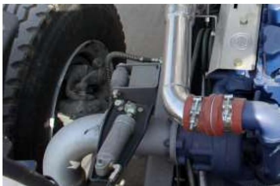
图 2-17 排气制动装置
