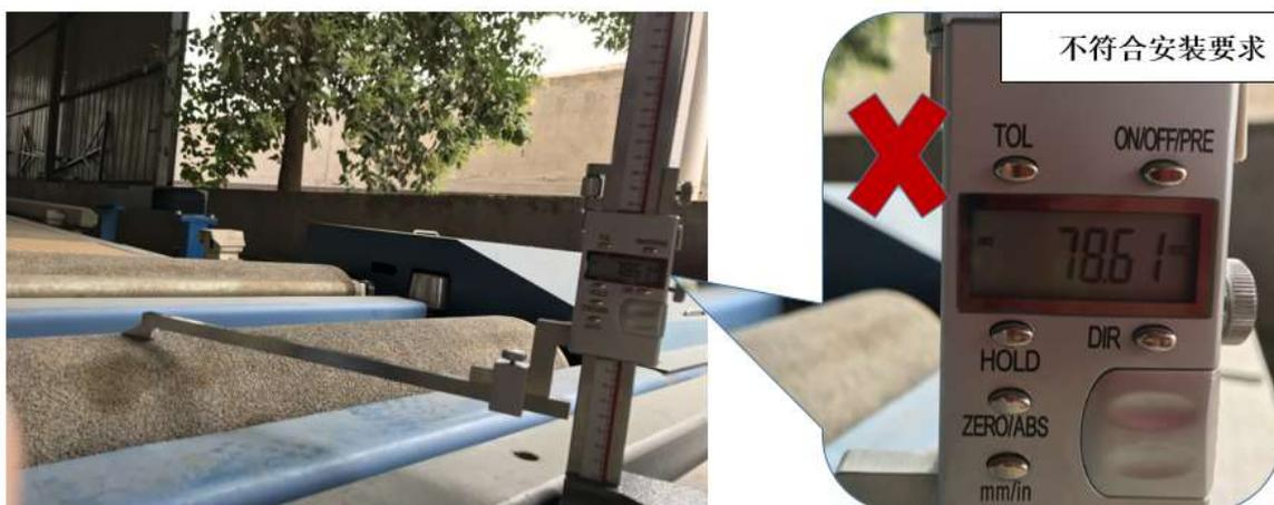
图 2-49 副滚筒离地初始高度不符合要求
