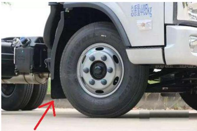
图 2-47 机动车防飞溅柔性突出部分
