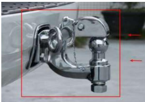
图 2-39 可拆卸的车辆用的挂接或拖曳装置
