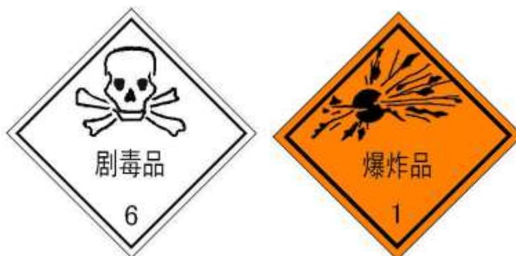
3、根据GB 20300的要求，道路运输爆炸品和剧毒化学品车辆除应安装符合GB 13392要求的标志牌和标志灯外，还应在车辆后部安装安全标示牌，安全标示牌的内容应与车辆类型相适应，在车辆的后部和两侧应粘贴橙色反光带以标示车辆的轮廓（如下图所示）。并且，厢式道路运输爆炸品和剧毒化学品车辆车辆的货厢外部颜色应为浅色。
